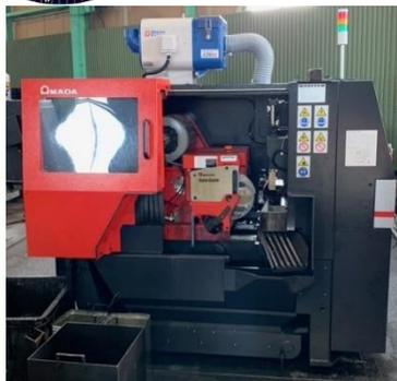
新しい機械CM II 75DGをリプレイスしました！従来機にはないDG（ダイナガイド）により高速・高精度切断が可能に！さらに！今まで明細を手入力していたのですが、この機械は作業指示書のQRを読み込み自動で入力してくれるのでポカミスする心配もなしです(\*´艸`)
